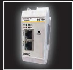
BACnet/IP で Syslog の監視を実現するゲートウェイ装置
